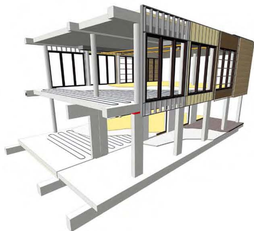
model, gevel aan de "kloostergang" gekeimd metselwerk
